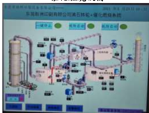
設備操作介面
